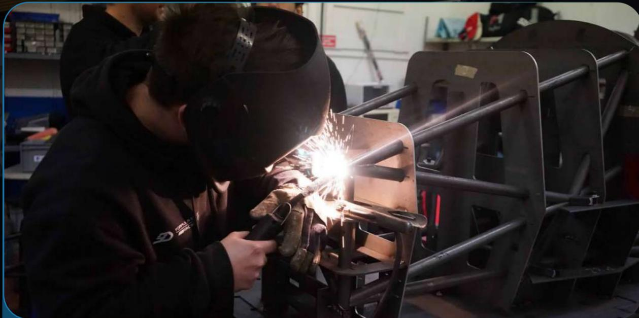
Durante estos meses se ha trabajado en la fabricación de la bancada y el chasis del DYN-07. Para posicionar esta bancada se ha diseñado, fabricado y montado una mesa donde se situará tanto la bancada del chasis como las de los demás departamentos.
